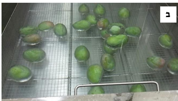
תמונה 1: אמבט האולטרה סאונד בו התבצע הניסוי; מבט מבחוץ (א.1) ומבט לתוך האמבט (1. ב.).
