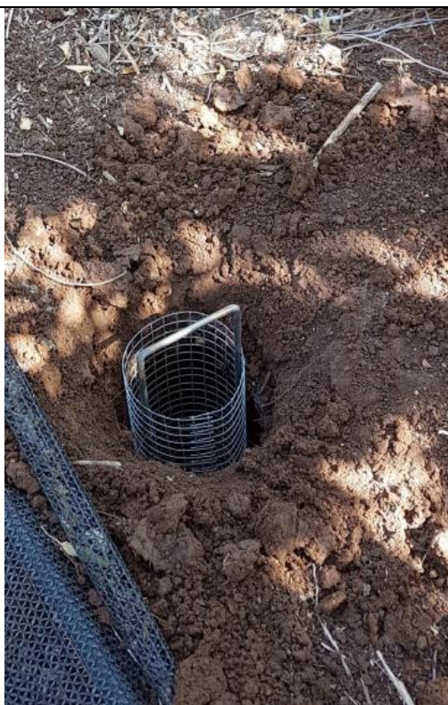
תמונה 2: הכנסת גלילי רשת עד לגובה פני הקרקע ומילוי בקרקע מקומית או מצע בהתאם לטיפול
